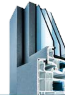
PAST 92 Kunststoff mit Alu-Vorsatzschale 92 mm Bautiefe U_f = 0,98 \text{ W/m}^2\text{K}
