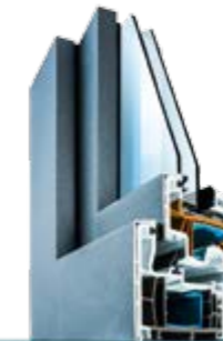
PAST 76 AluColor Kunststoff mit Alu-Vorsatzschale 76 mm Bautiefe U_f = 1,1 \text{ W/m}^2\text{K}
